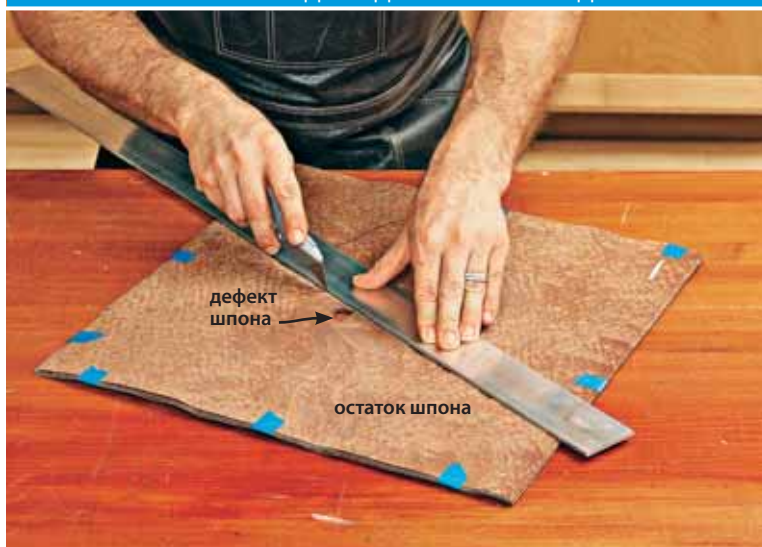
1. ПЕРВЫЙ РЕЗ ВДОЛЬ ДЛИННОГО КРАЯ ДЕТАЛЕЙ
